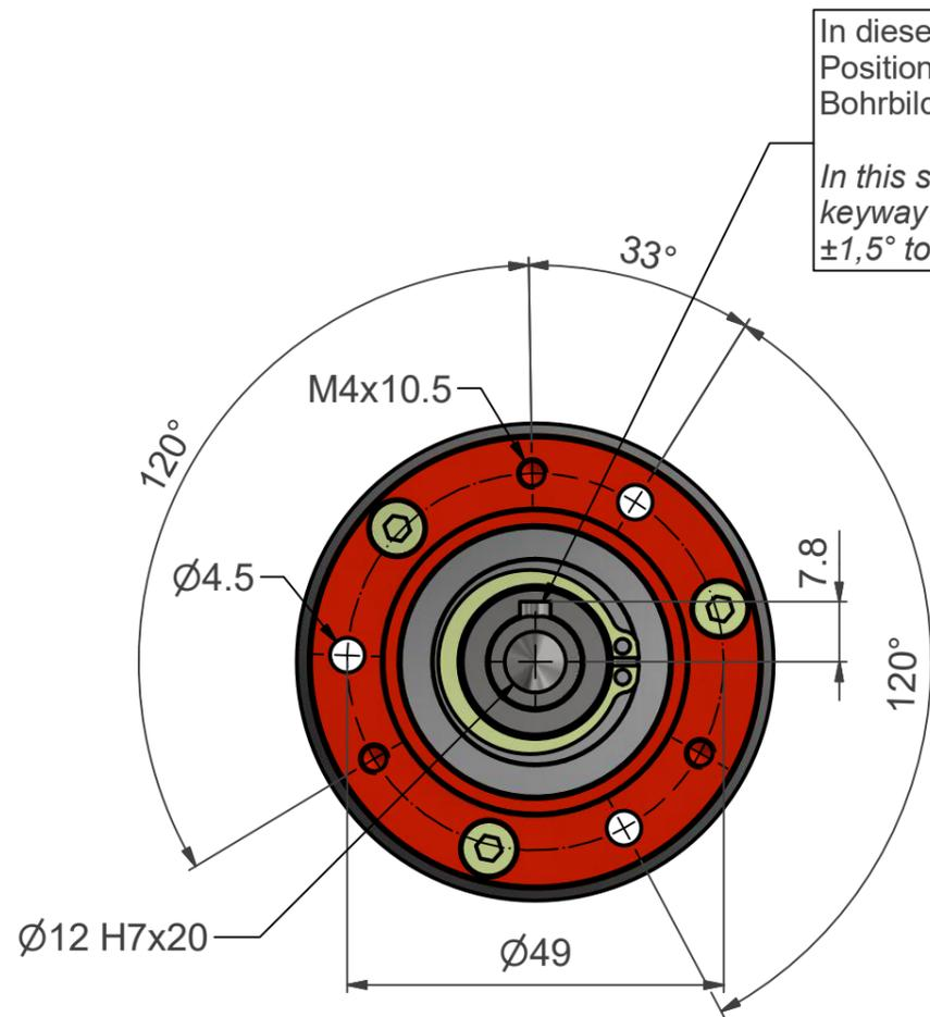
In dieser Lage kann die Position der Passfedernut zum Bohrbild  $\pm 1,5^\circ$  abweichen
