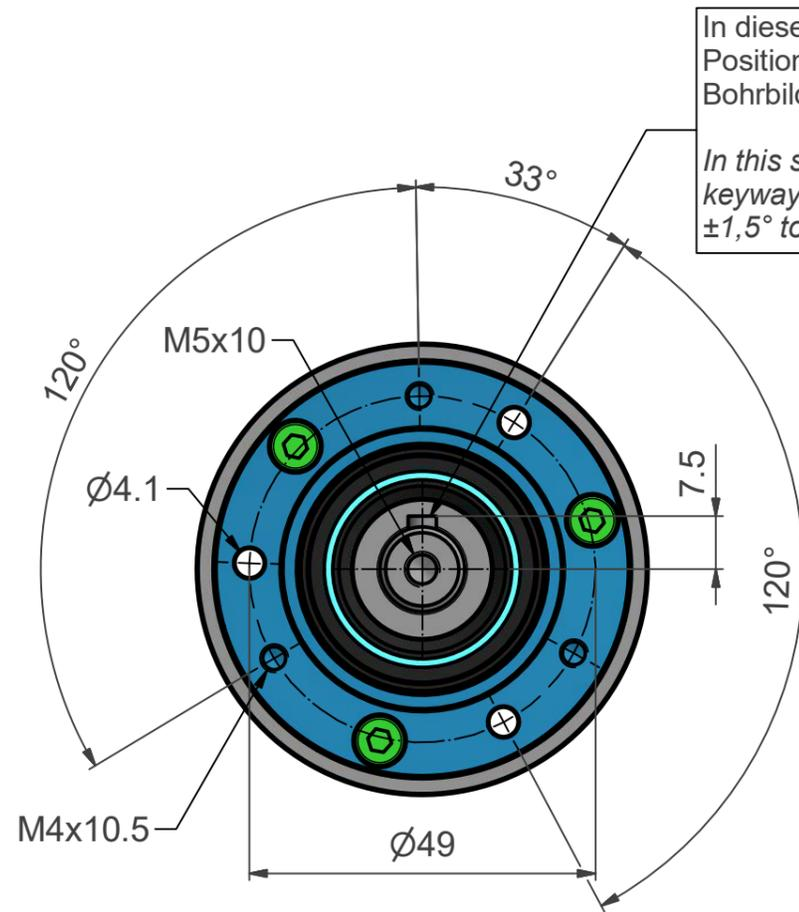
In dieser Lage kann die Position der Passfedernut zum Bohrbild  $\pm 1,5^\circ$  abweichen
